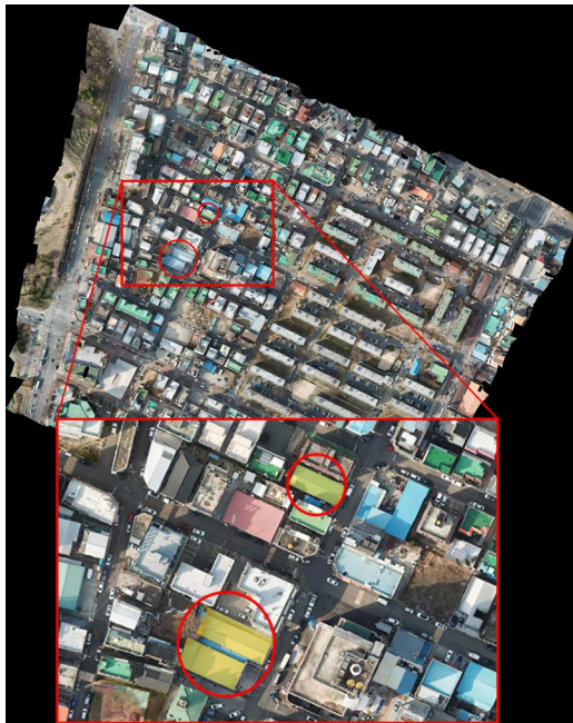
〔그림 3〕 샌드위치 패널 지붕 마킹
