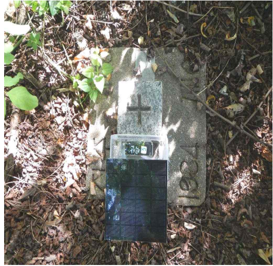
(그림 5) 전주408 기준점의 설치 당시 모습
